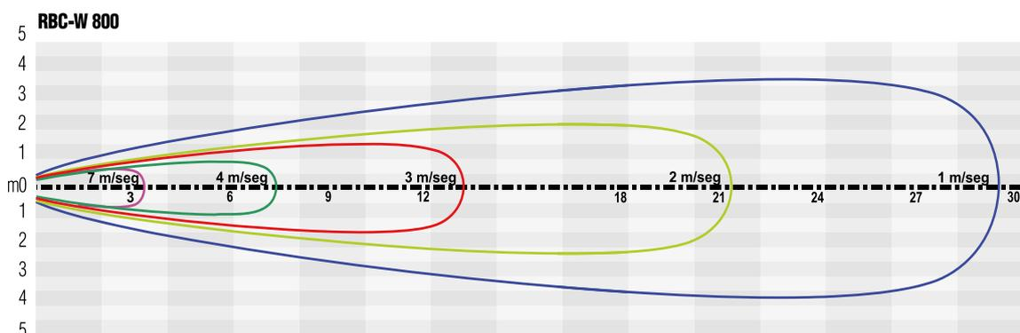
\*Datos obtenidos a condiciones estándar a máxima velocidad de operación. Velocidad: m/seg. Distancia: m
